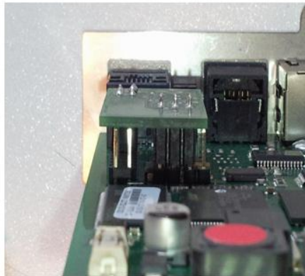
Abbildung 147: CS121 WDP auf einem CS121 SC/BSC – Ansicht von links und von hinten
